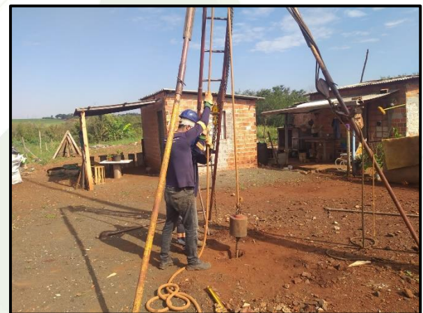
Execução de sondagem SPT
