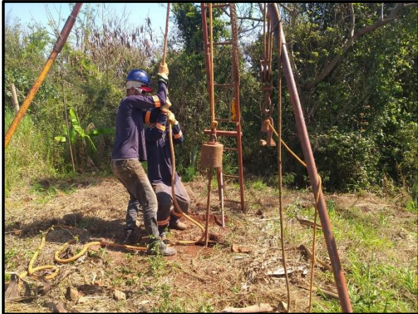
Execução de sondagem SPT
