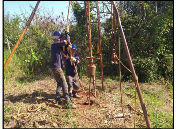
Execução de sondagem SPT
